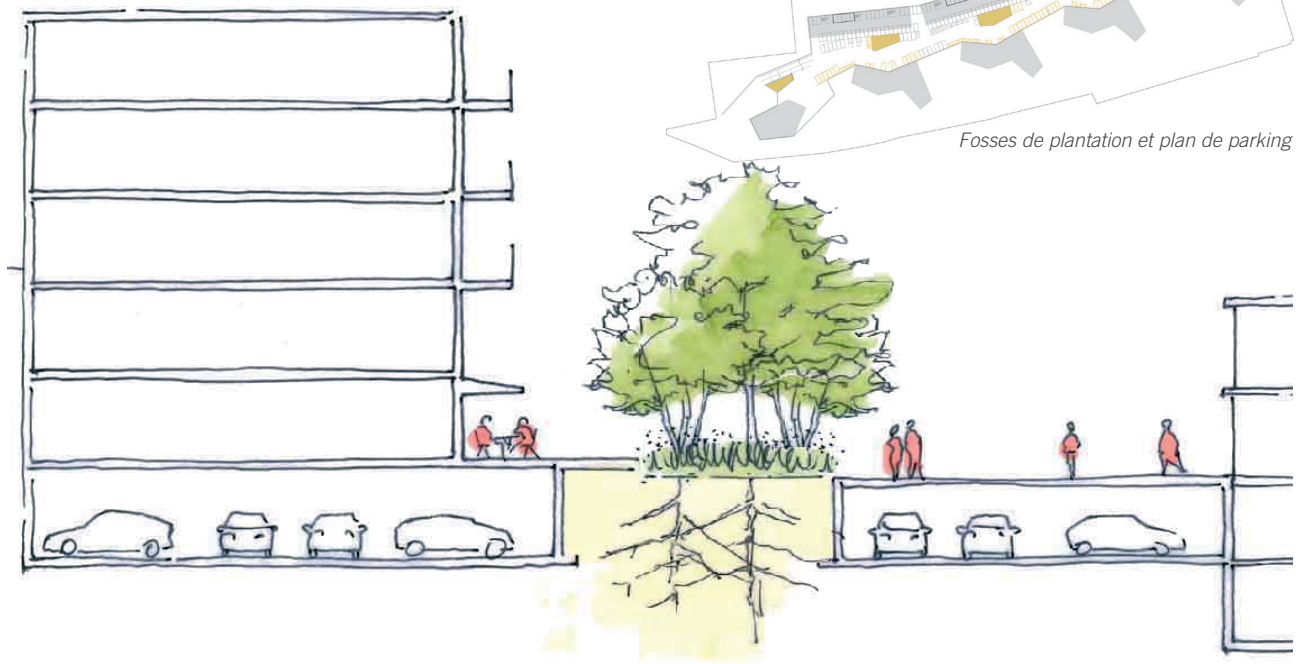
Plantations en pleine terre aménagées dans le parking souterrain
